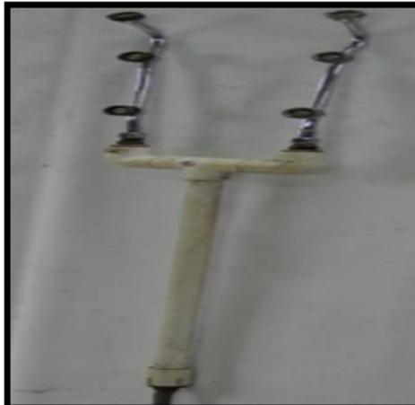
**Ilustración 23.** Lanza ecuatoriana de seis discos. Fuente: instructivo para manejo integrado.
