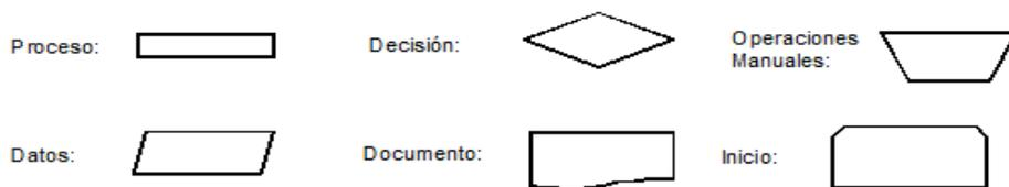
**Ilustración 28.** Diagrama de flujo Metodología para el objetivo específico 2 (NORMA: DIN 66001:96).
