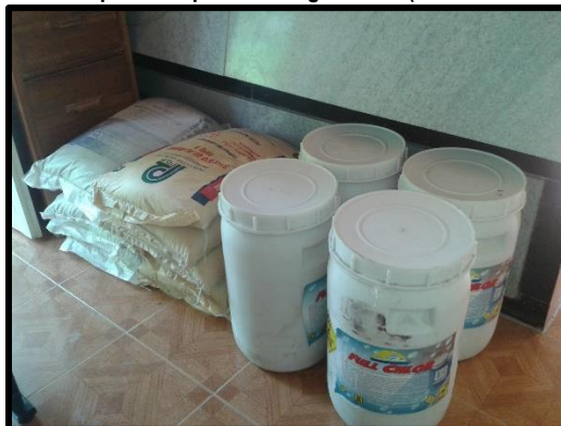
Fotografía 78 Insumos químicos para la Coagulación. (Sulfato de aluminio)
