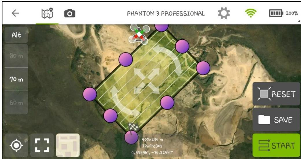
Imagen 13. Línea de vuelo en la aplicación *Pix4Dcapture*, Vuelo 1. Segmento 2.
