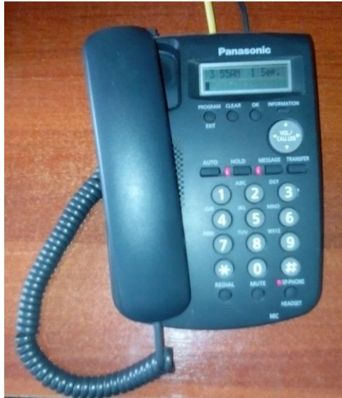
Figura 54. Teléfono IP. Fuente: Autores
