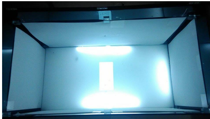
Figura 32 – Ubicación de la iluminación en la estructura física del sistema de visión artificial Autor.
