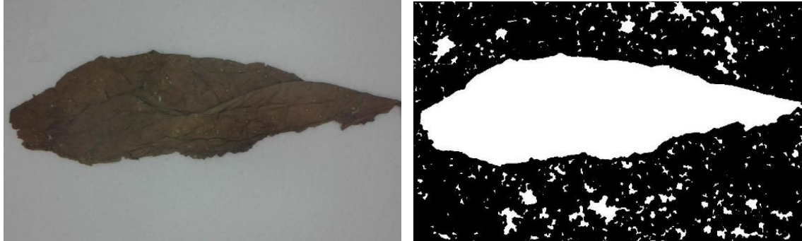
(A) (B) Figura 38 – Segmentación por descriptores morfológicos, (A) Imagen original, (B) Segmentación Autor
