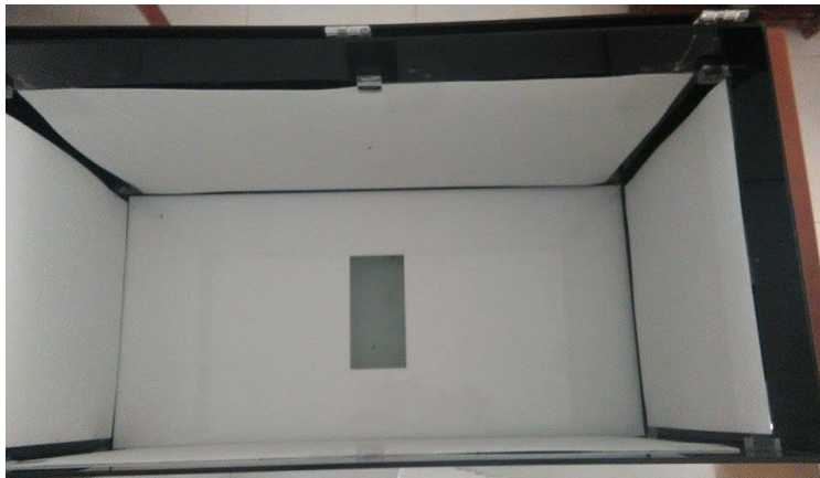
Figura 34 – Tapizado al interior de la estructura del sistema de visión artificial Autor
