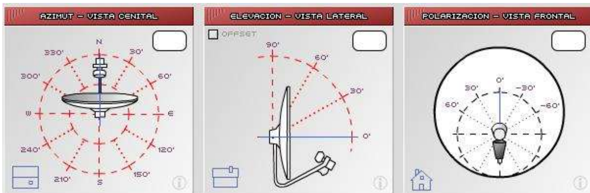
Fig 16 Azimut, Elevación y Polarización de una Antena.
