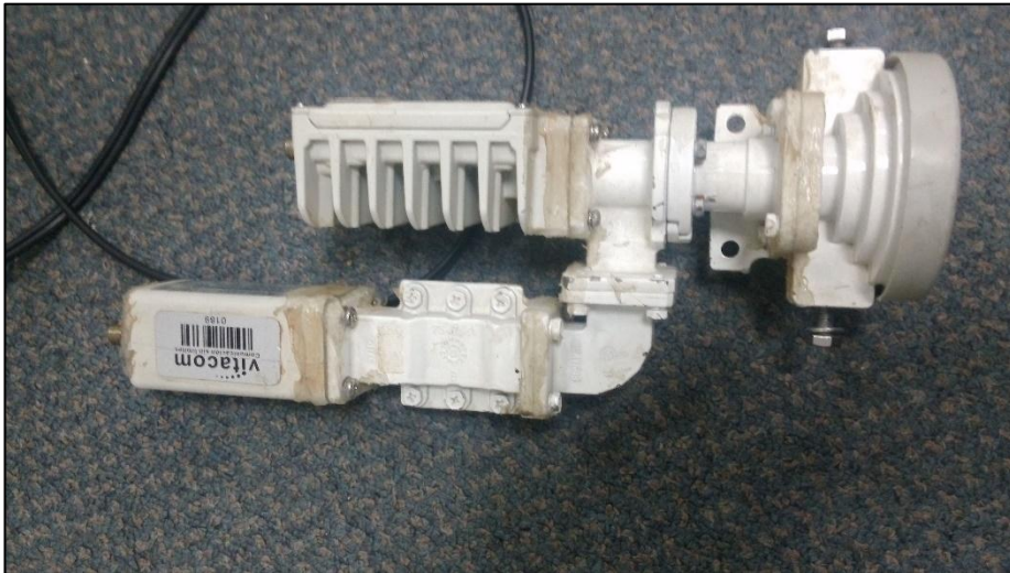
Figura 49. ODU Antenas VSAT
