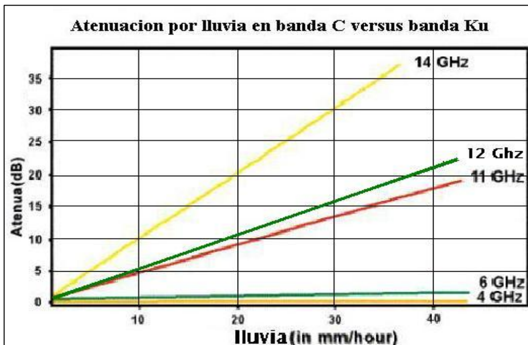
Figura 8. Atenuación que causa la lluvia con respecto a la frecuencia de la señal.
