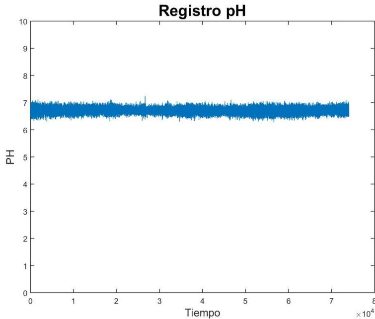
El registro de pH del sistema indica la calidad del agua que es procesada, en la figura 58 indica el comportamiento del sensor, Los datos muestran el registro que corresponde a un día de muestras, observando que el nivel de pH oscila entre 6.3 a 7 se obtiene que el agua se puede reutilizar, ya que se encuentra en muy buen nivel de pH, como se observa en la siguiente tabla.
