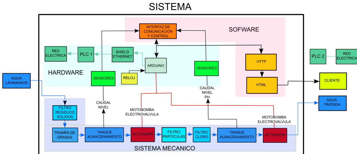
El prototipo está compuesto por diferentes etapas por donde pasa el agua para ser tratada, además se lleva un registro del comportamiento y estado del líquido. Las etapas que tiene el sistema son: trampa de grasas, almacenamiento de agua pre procesada, proceso químico y almacenamiento final.
