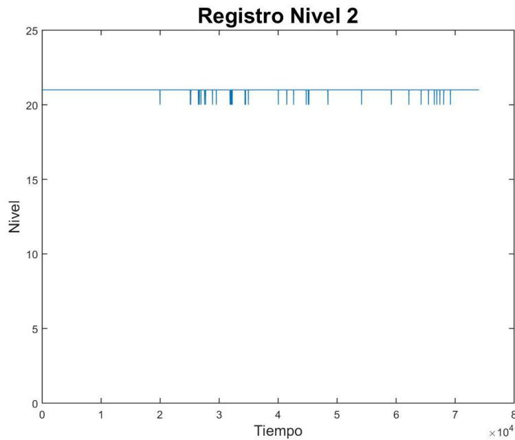
En la gráfica se comprueba el correcto funcionamiento de los sensores de nivel del tanque número 2, al igual que mantiene el nivel de referencia, y este presenta la variación al entrar agua en el tanque (nivel máximo 21 cm, nivel mínimo 20 cm).
