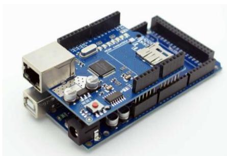
Figura 85, Modulo shield de Ethernet
