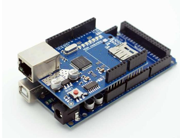
La Shield de Ethernet permite al Arduino conectarse a internet por medio de un cable rj45, puede soportar hasta un máximo de 4 Shield simultáneas y solo es necesario utilizar la biblioteca de Ethernet. También añade una ranura para tarjetas micro-SD, la cual se puede utilizar para almacenar archivos utilizando la biblioteca SD. El protocolo de comunicación que utiliza es de un módulo w5100 y la tarjeta SD utiliza el bus SPI.
