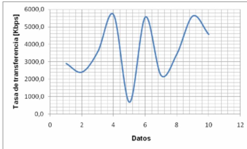
De acuerdo al porcentaje de la tasa máxima y tasa promedio, se obtuvieron buenos resultados en la transmisión de datos a pesar de que la tecnología PLC presenta disminución apreciable en los empalmes y en el cambio de calibre en los conductores.
