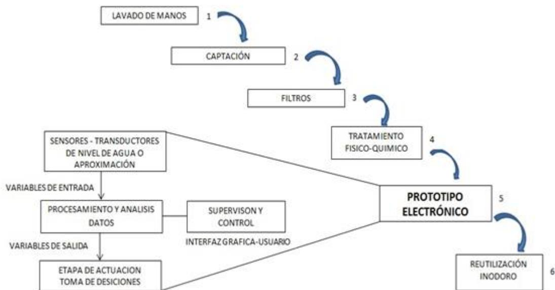
Figura 75, Diagrama funcionamiento
