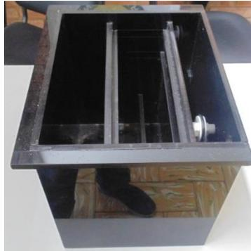
La tercera parte del prototipo, es un tanque en acrílico de 8mm, el cual tiene como medidas 31 cm de alto, 27 cm de ancho, 31 cm de largo, en el cual se almacena el agua que pasa de la trampa de grasas, este en su interior tiene una motobomba y un sensor de nivel e-tape.
