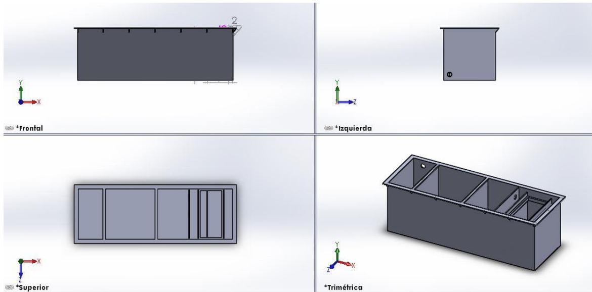
A este prototipo inicial se le realizan diferentes modificaciones en relación a lo principalmente planteado, ya que por motivos de ensamblaje tal como tubería, disposición de elementos, se procede a realizar la modificación, de un solo tanque con 4 cubículos, a 3 cubículos ensamblados por aparte.
