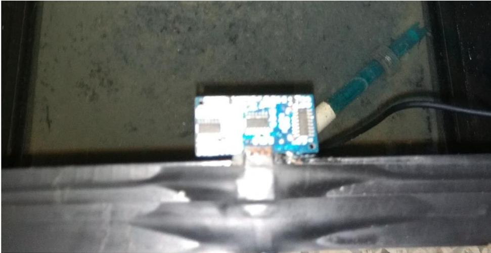
Se agrega un sensor de caudal o caudalimetro digital, al final del prototipo, para corroborar la información dada por el sensor de caudal o caudalimetro análogo de la salida del agua del prototipo.
