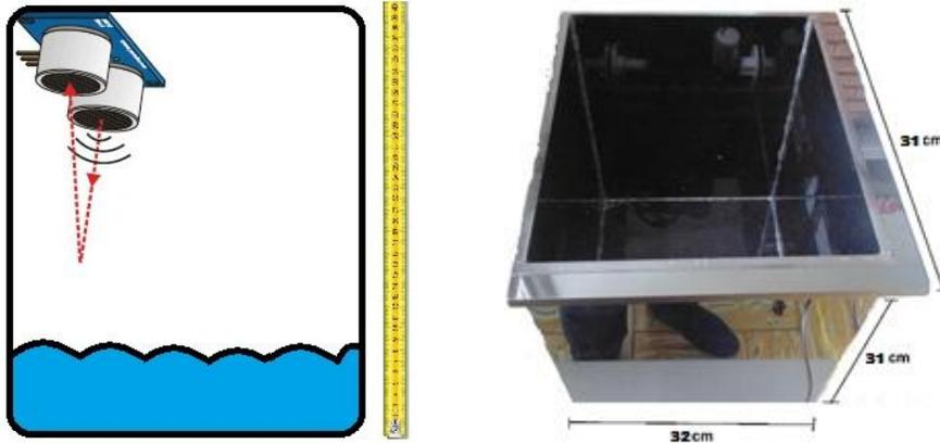
En la anterior imagen se relaciona las medidas de uno de los tanques y la medida en la que se encuentra el sensor, todas estas medidas pueden ser variadas según el prototipo.
