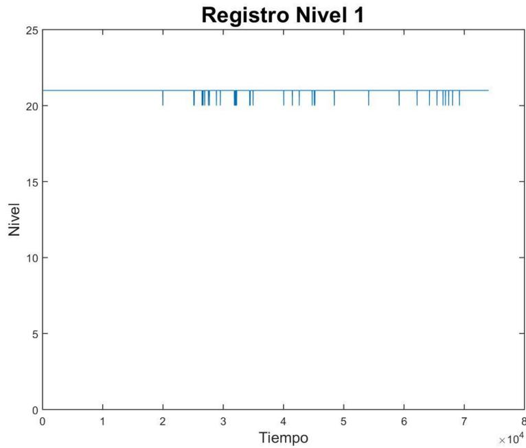
En la gráfica se comprueba el correcto funcionamiento de los sensores de nivel del tanque número 1, al igual que mantiene el nivel de referencia, y este presenta la variación al entrar agua en el tanque (nivel máximo 21 cm, nivel mínimo 20 cm).
