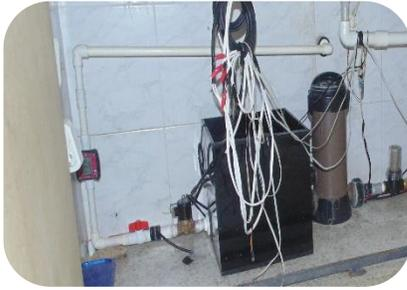
Vista acometida agua saliente del prototipo a desagüe con Tubo PVC 1/2.
