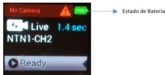
Ilustración 28. La flecha color azul señala el estado de la batería
