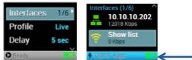
Ilustración 11 El icono del estado de la batería aparece en la parte inferior de todas las ventanas de la pantalla principal
