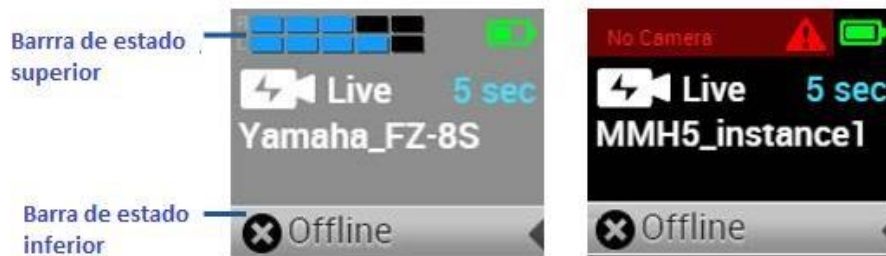
Ilustración 10 Barras de estado superior e inferior con indicadores de transmisión y canales de audio
