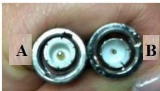
Ilustración 33. Conectores y cables BNC, el conector indicado para la unidad LU200 es el conector B.
