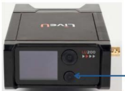
Ilustración 9 La flecha color azul señala el encendido
