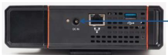
Ilustración 8 La flecha color azul señala la entrada DC, el LED rojo se enciende cuando se encuentra descargado, verde cuando está cargado
