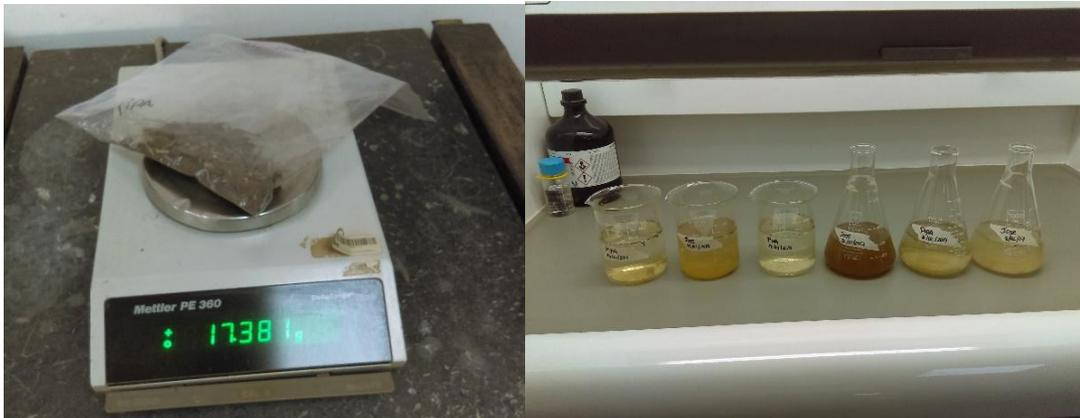
Figura 13. Derecha Aplicación de ácido sulfhídrico a los sedimentos. Izquierda peso de agregados del suelo. Fuente: Autor, 2017
