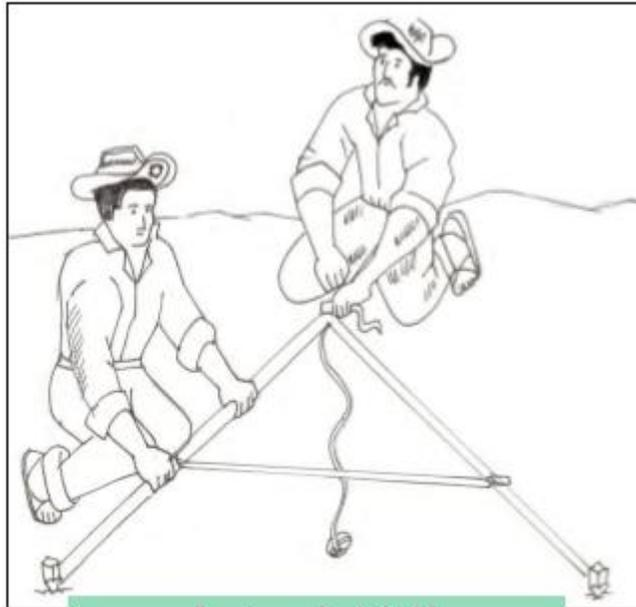
Figura 6. Armado de agro nivel. Fuente: (Camacho S.f)
