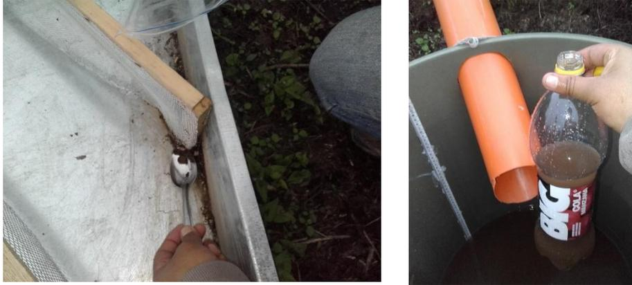
Figura 12. Derecha Toma de agua con sedimentos del tanque recolector Izquierda recolección de agregados del suelo sobre la canaleta. Fuente: (Autor, 2017)
