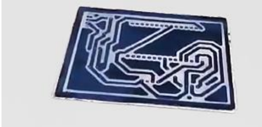
Figura 33. Diseño PCB con grabadora láser
