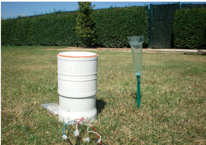
Figura 7. Prueba de funcionamiento del pluviómetro construido comparado con uno manual [15].
