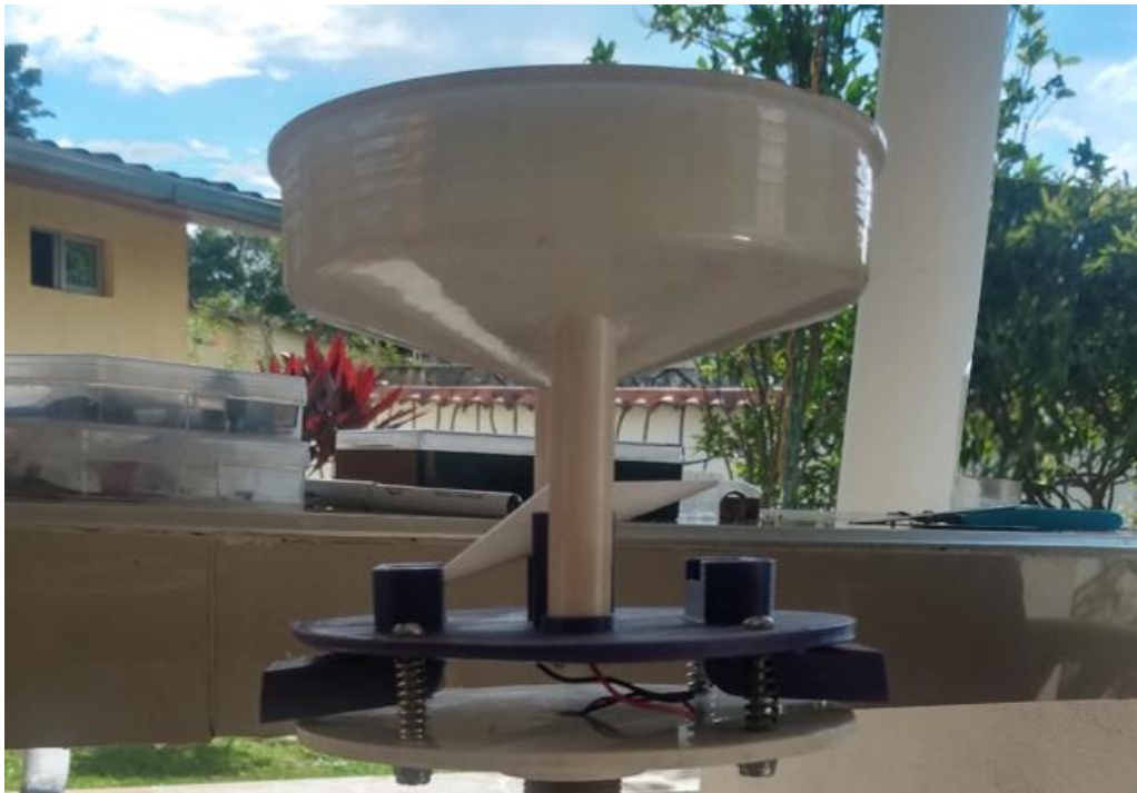
Figura 32. Construcción pluviómetro digital con balancín.
