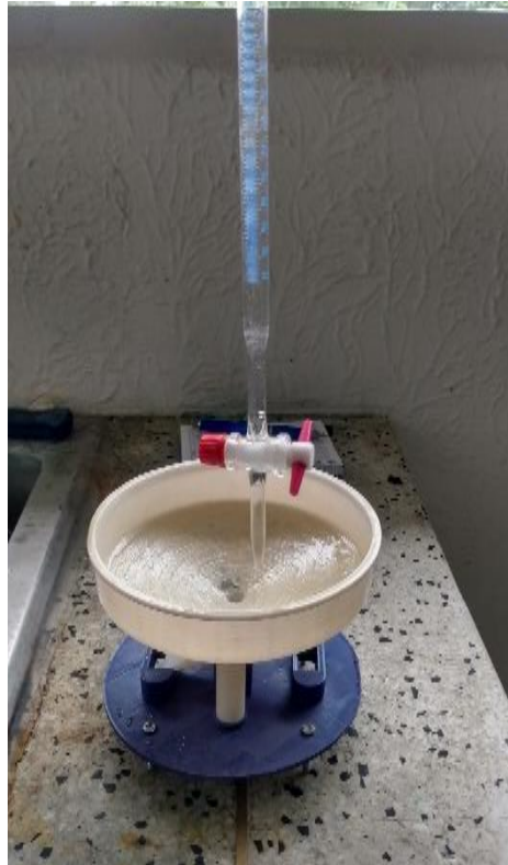
Figura 39. Medición de la capacidad del volumen de agua del balancín con una bureta.
