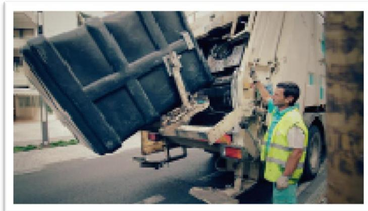
**Ilustración 46 Vaciado del contenedor sobre el camión compactador
