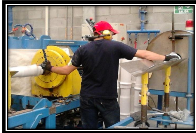
Ilustración 24. Proceso de horneado en acampanadora
