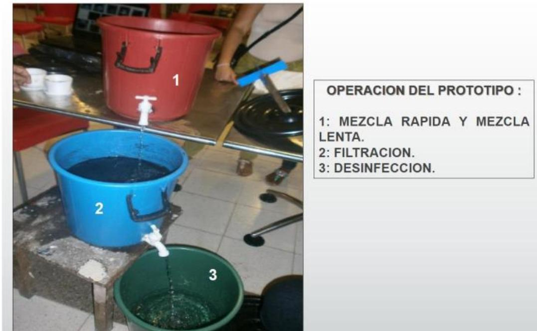
Ilustración 3. Prototipo portátil de un sistema de potabilización convencional. Fuente: Pasqualino et al., 2015.
