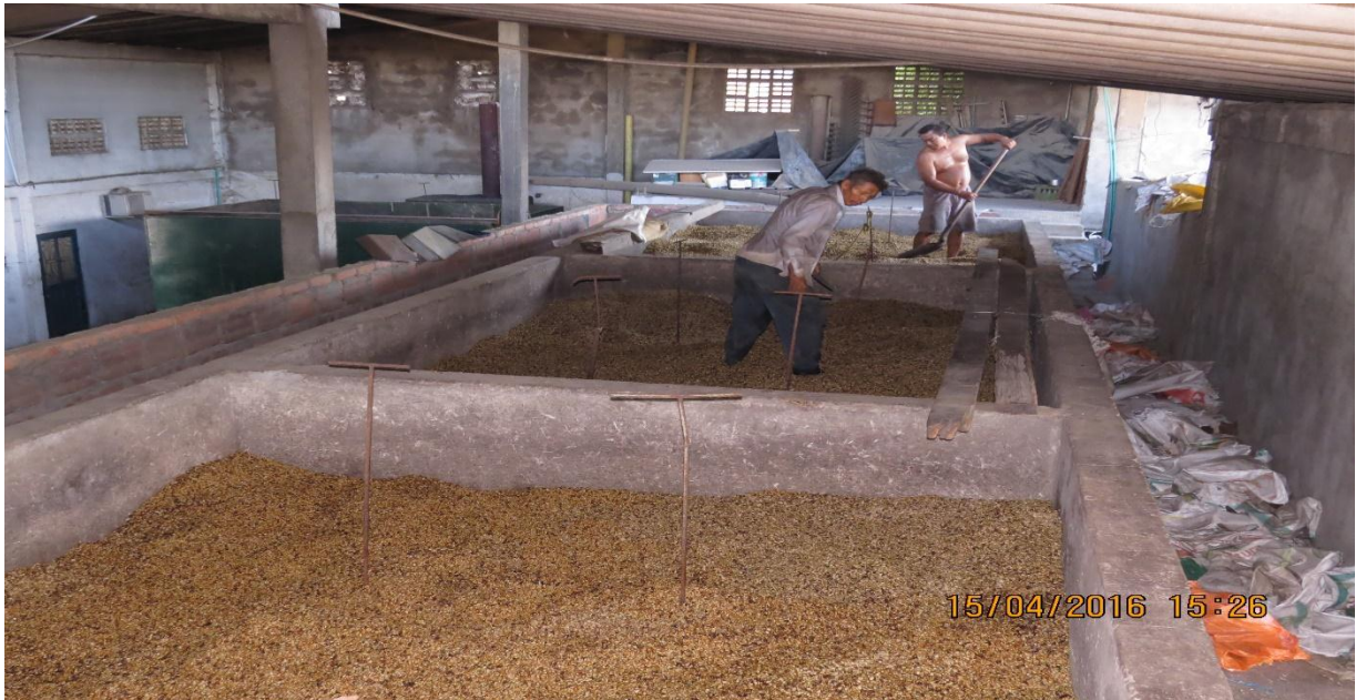
Figura 9. Trabajadores de la cooperativa emparejando el café para el secado con vapor.
