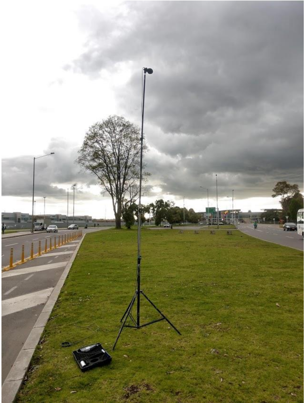
Anexo 3 estructura de medición de ruido ambiental
