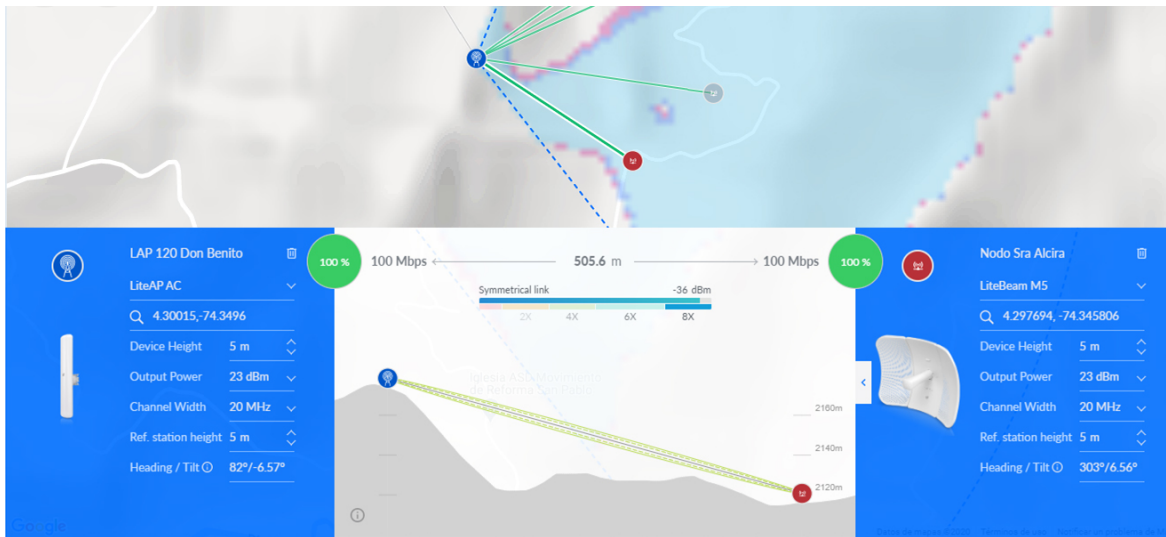
Ilustración 30 Resultados de la simulación de radioenlace PTMP entre el cerro de la Finca de Don Benito y la finca de la Sra. Alcira.
