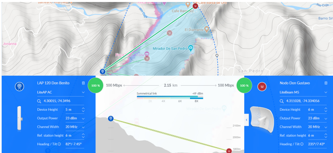
Ilustración 34 Resultados de la simulación de radioenlace PTMP entre el punto de acceso ubicado en la finca de Don Benito y la finca de Don Gustavo.
