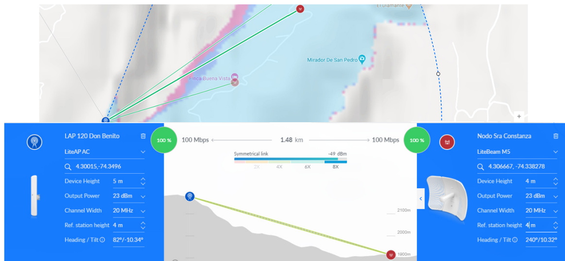
Ilustración 33 Resultados de la simulación de radioenlace PTMP entre el punto de acceso ubicado en la finca de Don Benito y la finca de la Sra Constanza.
