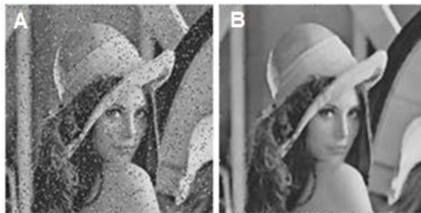
Figura 6. (A) Imagen con ruido (B) Imagen filtrada. Tomado de mathworks.com .
