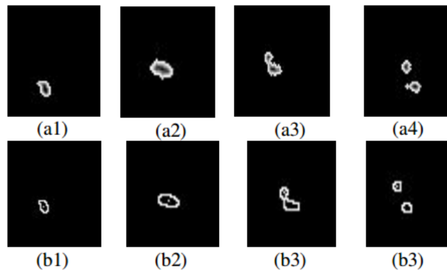
Figura 11. Fotografías 1-4. (a) Transformada distancia euclidiana. (b) Algoritmo Watershed con centroide detectado. Tomado de M. Ravanfar et al., 2011.
