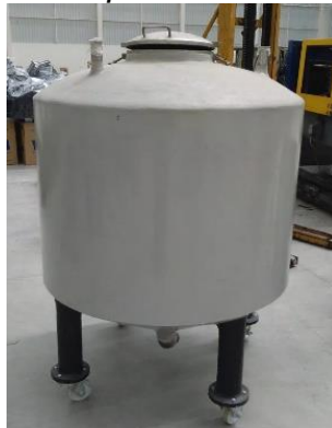
Figura 24. Tanque frio en fibra de vidrio
