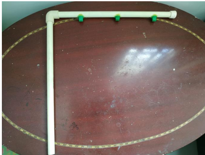
Figura 69. Tubo PVC con sus respectivas boquillas de abanico
