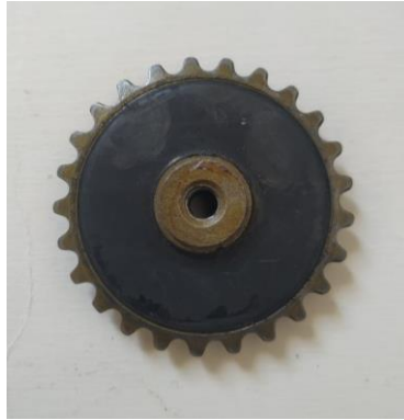
Figura 60. Piñón de 2 pulgadas implementado en los ejes de los rodillos
