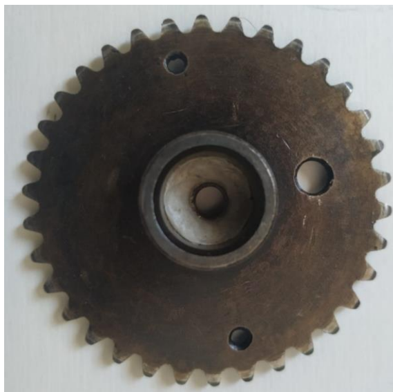
Figura 62. Piñón de 3 pulgadas implementado en el eje del primer rodillo
