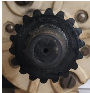
Figura 61. Piñón de 1,5 pulgadas implementado en el eje del motor
