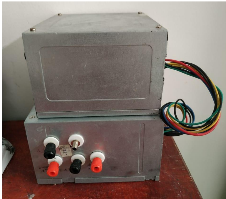
Figura 58. Fuentes de voltaje en paralelo
