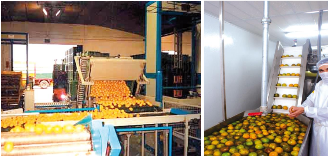
Figura 5. Volcado en seco y en agua Fuente: (Catarina Pedro Pássaro Carvalho, 2012)
