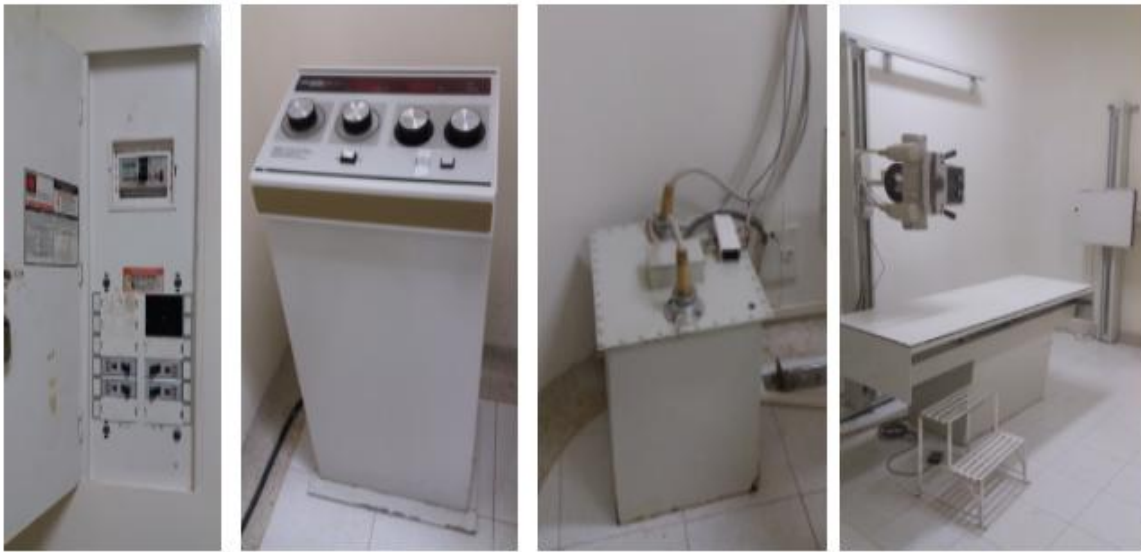
Figura 3 .Equipo de rayos X fijo TXR 325D (Autor)
