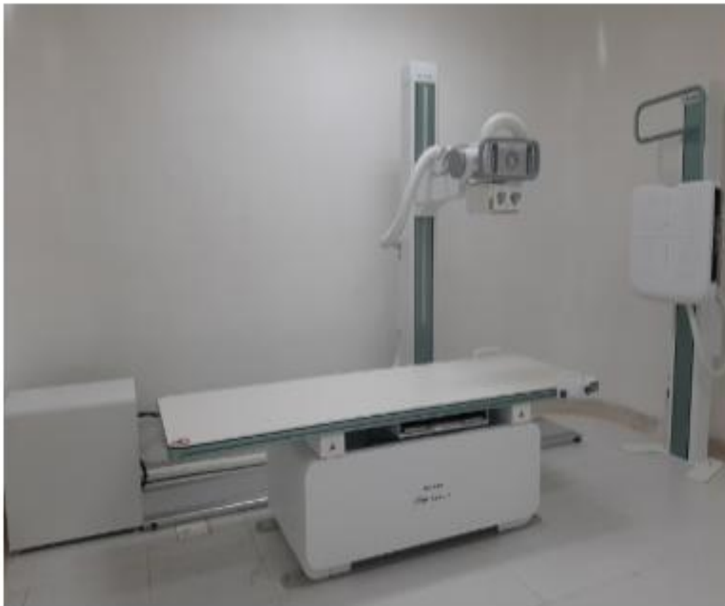
Figura 4. Equipo de rayos X fijo FDR SMART FGXR-S (Autor)
