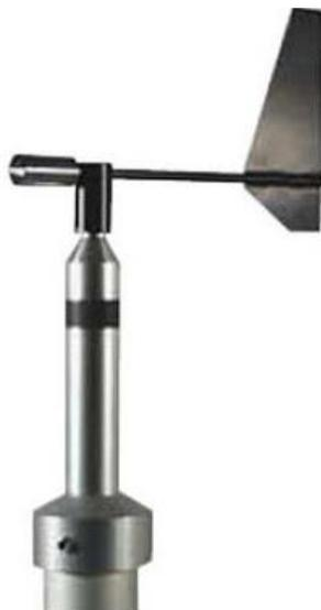
Figura 21. Sensor de dirección de viento (veleta)
