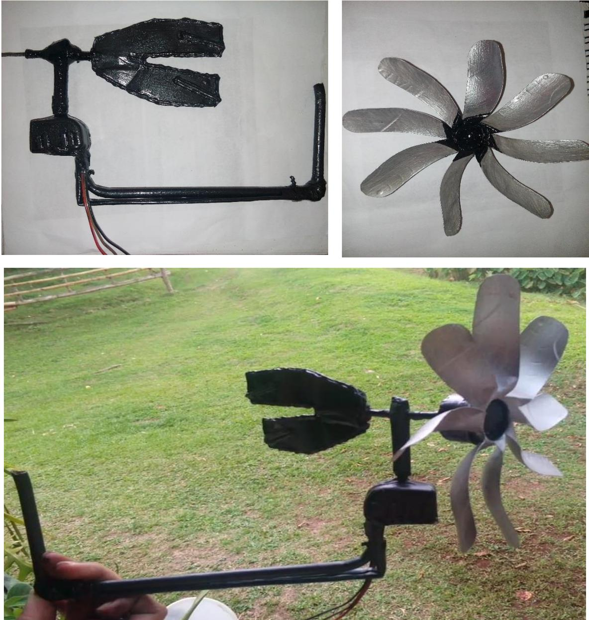
*Figura 48. Sistema de detección de la dirección del viento
