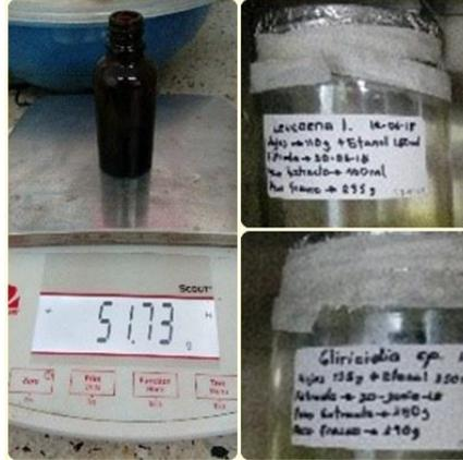
**Figura 10.** Pesaje y traspaso de las muestras
