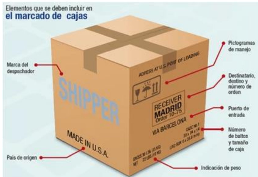
Figura 43 Elementos que se deben incluir en el marcado de una caja Fuente: AnaPadinRamos.wordpress.com
