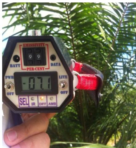
Figura 15 Termómetro infrarrojo AGRI-THERMS III™ (Fuente: Autor, 2018)
