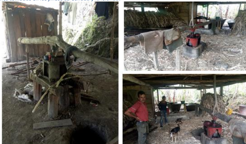
Figura 11-16 Fotografías de los trapiches usados para la producción de panela en el municipio de Topaipí, imágenes tomadas en las fincas La Cañada y la Isla.
