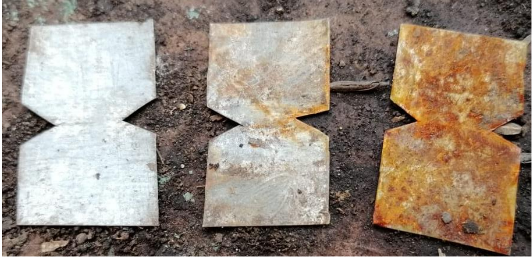
Imagen 32 Oxidación de la lámina de zinc.
