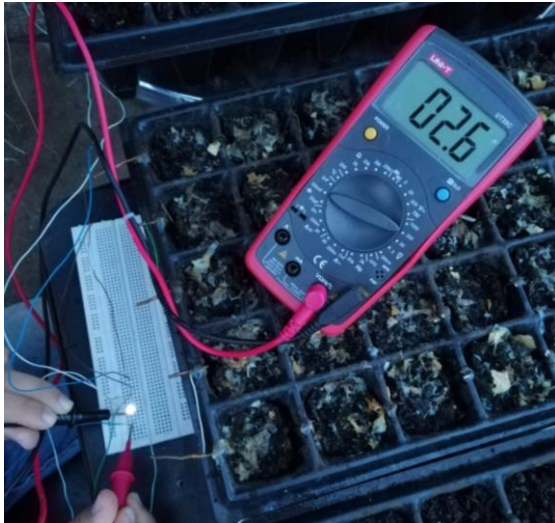
Imagen 53 Medición de voltaje en la serie con un led conectado
