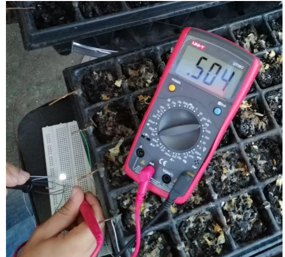
Imagen 57 Medición de corriente en el paralelo con un led conectado
