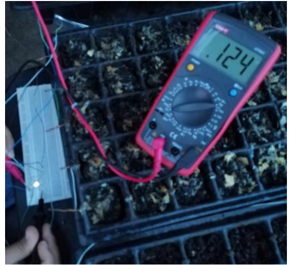
Imagen 54 Medición de corriente en la serie con un led conectado
