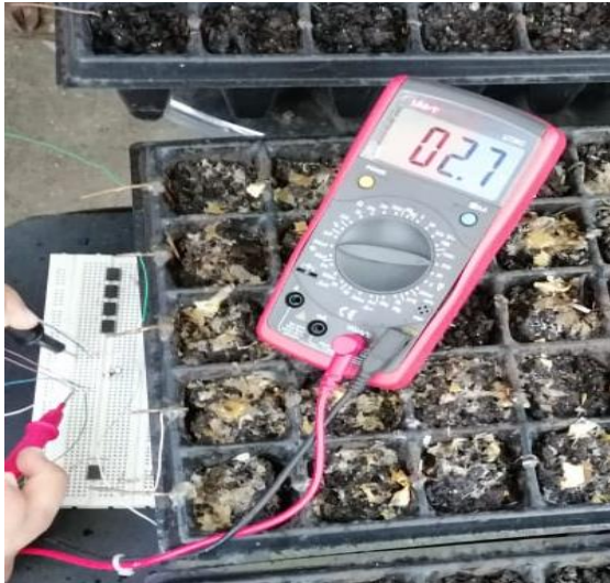
Imagen 56 Medición de voltaje en el paralelo con un led conectado
