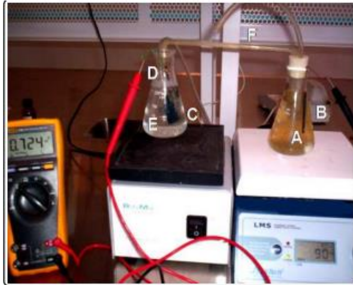
Imagen 6 Reactor piloto para celdas de combustible microbiana.
