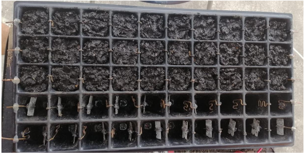
Imagen 46 Conjunto de cubos conectados en serie.
