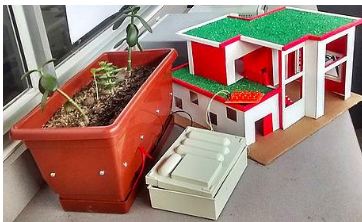
Imagen 17 Prototipo que usa la energía de las plantas para generar energía eléctrica.
