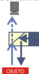
Figura 22 Sistema de iluminación, axial difusa
