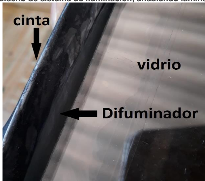
Figura 33, Rediseño de sistema de iluminación, añadiendo lamina difuminadora.
