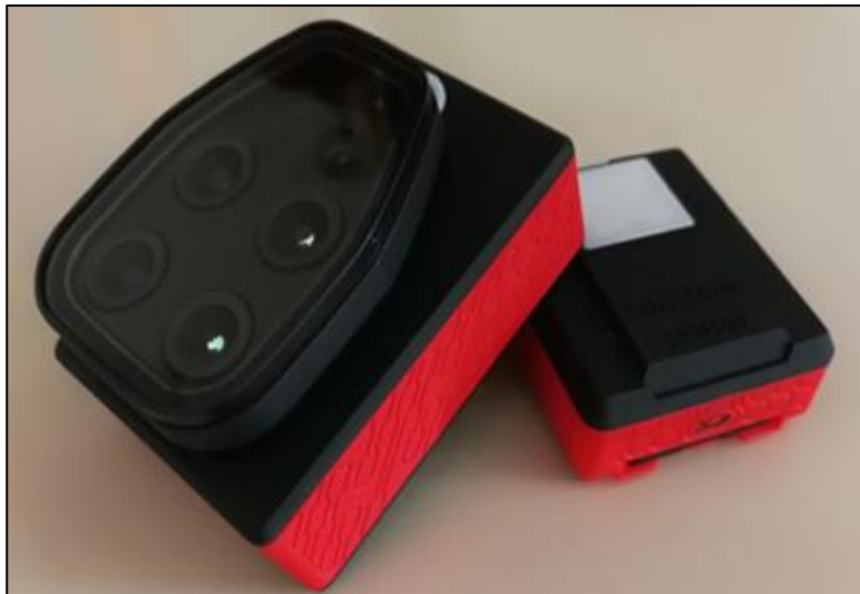
Figura 3. Cámara multispectral Parrot sequoia
