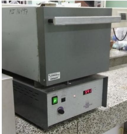
Figura 12. Mufla de incineración. Fotografía tomada por el autor
