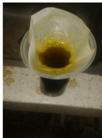
Imagen 17. Filtración del EET (Autores)
