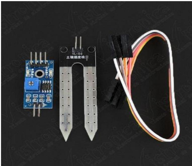
*Ilustración 6 Sensor de Humedad del Suelo. Tomado de CITATION VIS \I 3082 (VISTRONICA S.A.S, , s.f.)*
