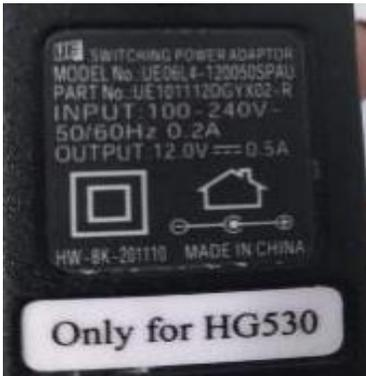
Ilustración 13 Adaptador de 12V Fuente: Autores
