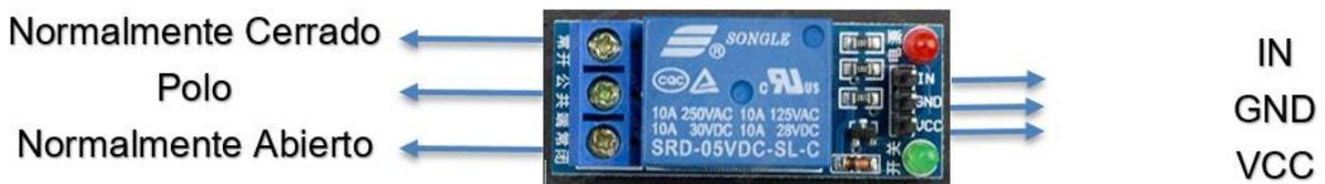
Ilustración 3 Modulo relé y sus terminales Fuente: Propia
