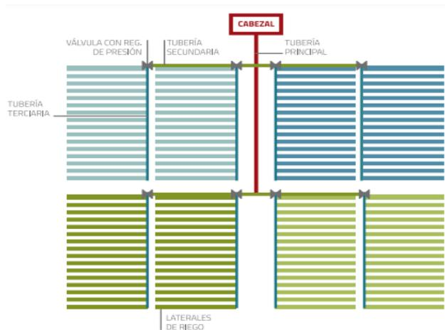
*Ilustración 1. Esquema de un sistema de riego presurizado. Tomado de (Liotta, 2015)*
