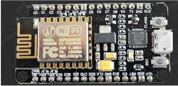
Ilustración 4 Modulo Wifi NodeMCU ESP8266 Tomado de (VISTRONICA S.A.S, , s.f.)
