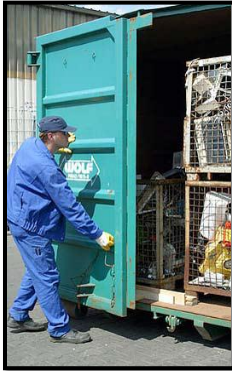
Figura 21. Contenedor de RAEE'S en cajas metálicas de rejas.
