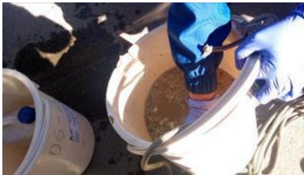
Figura 33. Muestreo Puntual Caja de inspección Externa, empresa No. 1. Fuente: elaboración propia.
