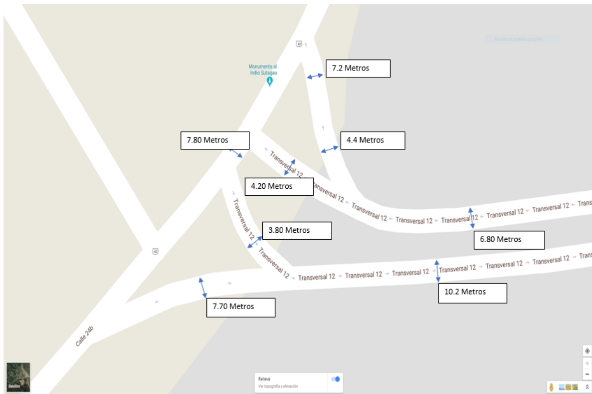
Ilustración 18. Medida del ancho de las vías de la Intersección Trv. 12 – Vía Panamericana (El Indio).
