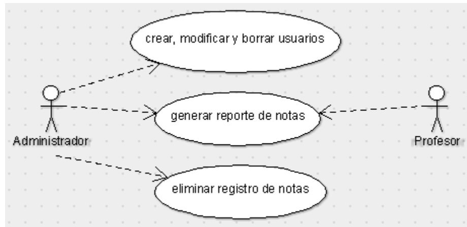
Ilustración 18 Diagrama de caso de uso sobre los permisos del administrador y el docente
