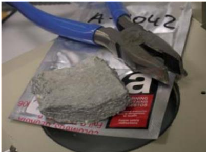
Figura A1.8 Material NO FRIABLE (fibrocemento)
