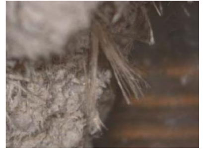
Figura A1.5 Material con amianto AMOSITA (60 X)
