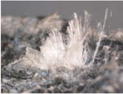
Figura A1.3 Material con amianto CRISOTILO (60 X)
