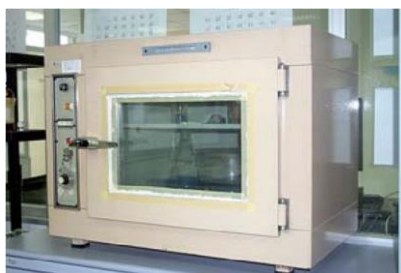
Figura A1.41 Junta aislante en la estufa de secado. Figura A1.42a y b Materiales diversos (pinzas, rejillas: FRIABLES) puerta de una estufa de secado
