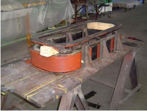
Figura A1.35 Aislamientos eléctricos en una bobina
