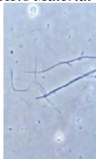
Figura A1.10 Fibras de amianto en filtro para recuento
