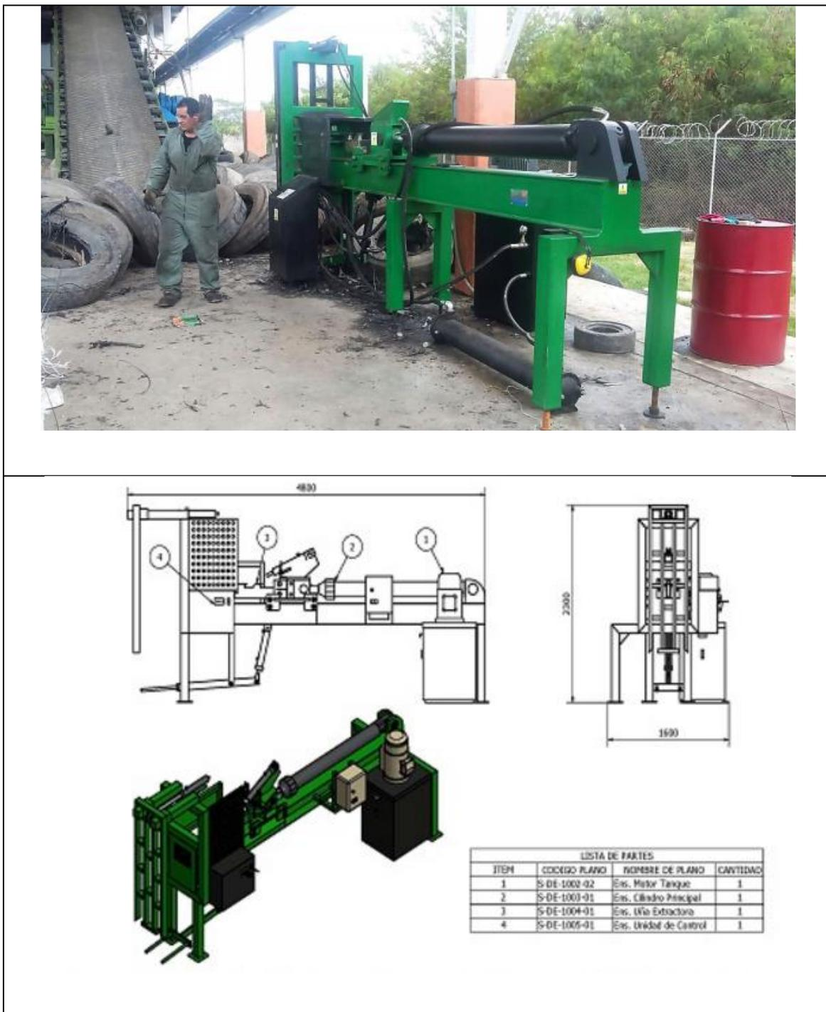
**Figura 18 Ilustración destalonadora**
