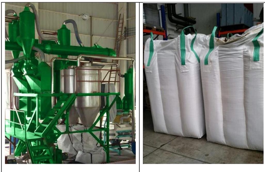
Figura 23 Ilustración sistema de extracción de fibra de nylon y polvo
