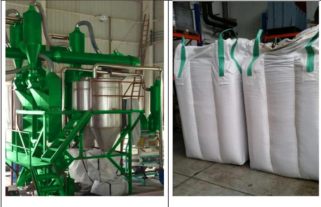
**Figura 31 Ilustración sistema de extracción de fibra de nylon y polvo**
