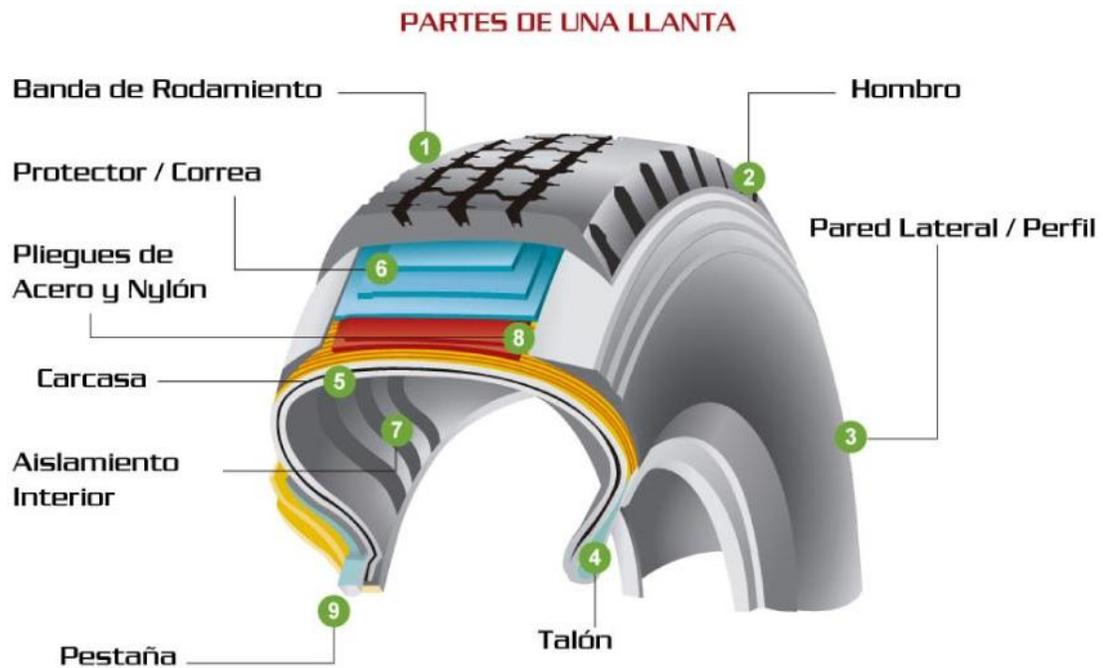
**Figura 12 Partes de las llanta**
