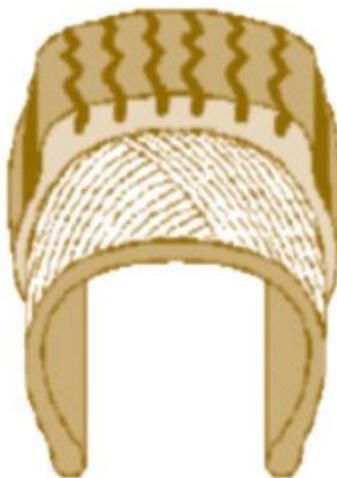
**Figura 14 Estructura radial**
