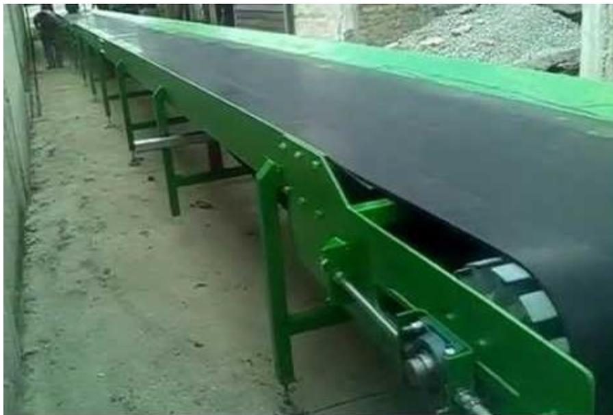
**Figura 28 Ilustración cinta transportadora**
