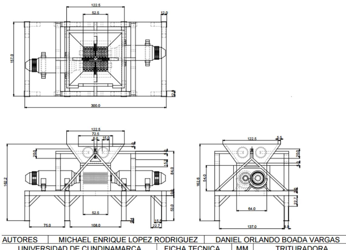
**Figura 36 Planos máquina de triturado (Sub-proceso B)**
