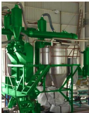
Figura 36. Sistema De Extracción De Nylon Y Polvo
