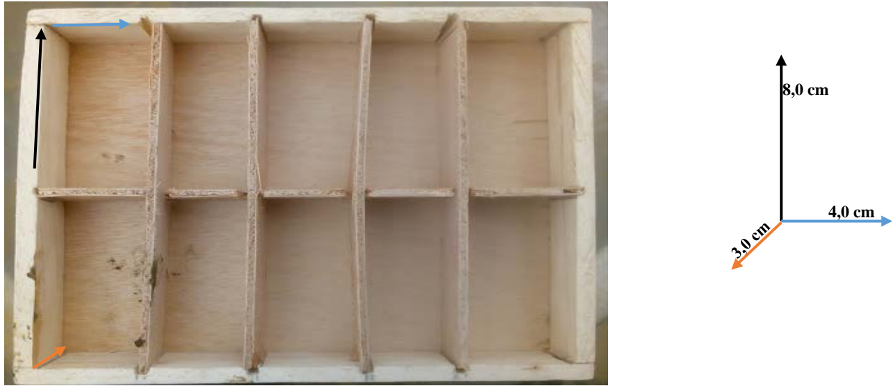
Figura 31. Molde para la fabricación de las unidades de ladrillos
