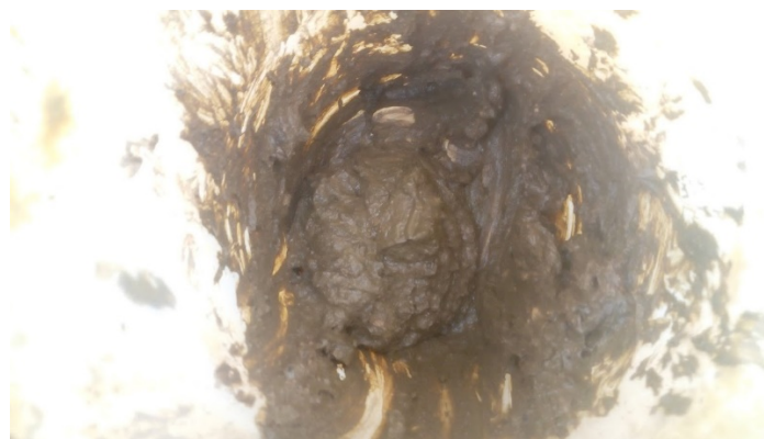
Figura 30. Mezcla de lodo para preparación de los ladrillos
