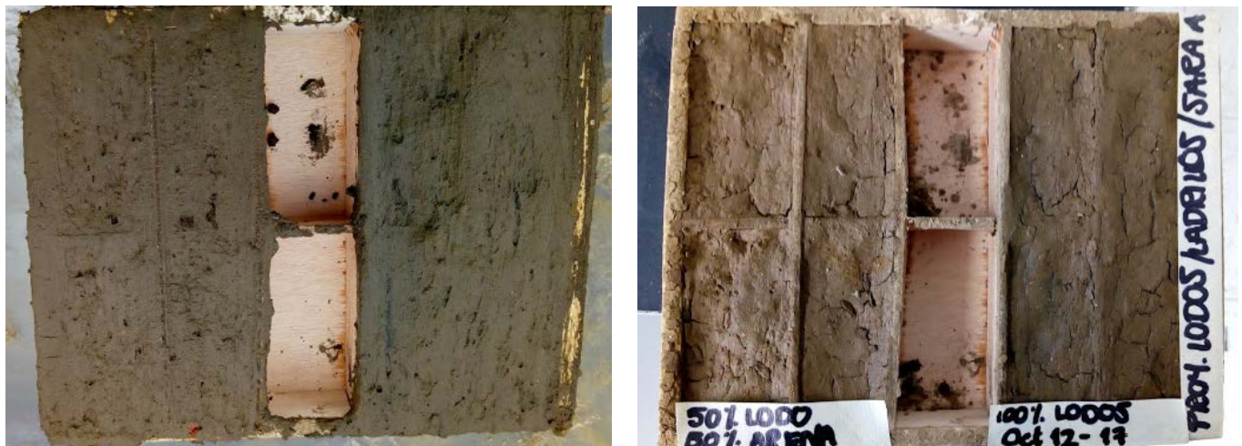
Figura 32. Moldeo de ladrillos de arena y lodo
