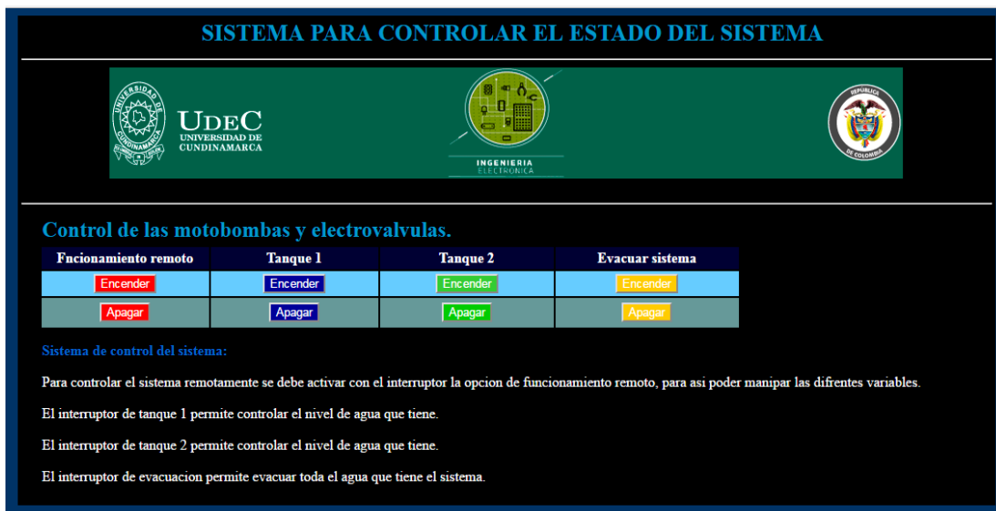
Figura 88, Interfaz del control remoto del sistema.
