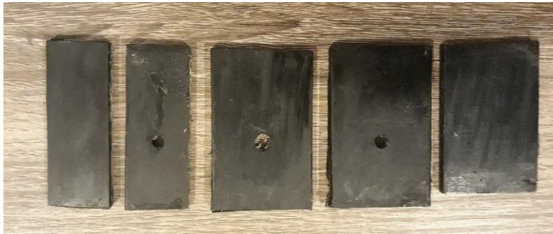
Figura 36. Laterales plasticos para construcción de celda.
