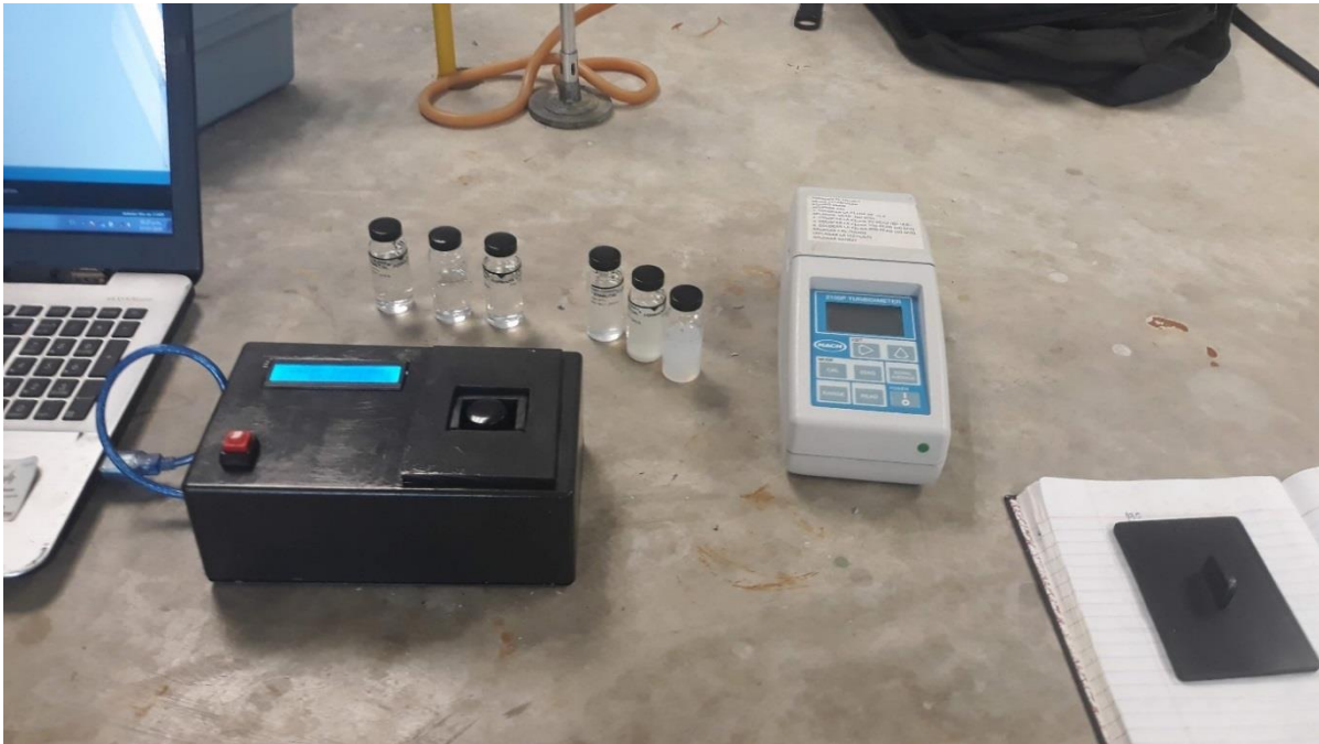
Figura 47. Proceso de tomas de muestra y caracterización con turbidímetros.
