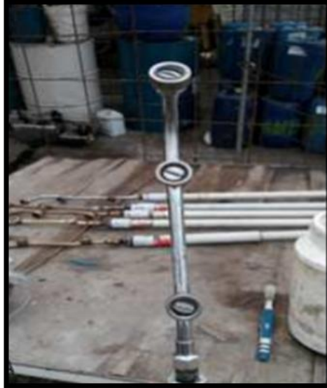
Ilustración 22. Lanza japonesa de tres discos. Fuente: instructivo para manejo integrado.
