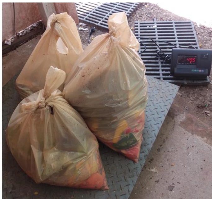
Imagen 7. Metodología de cuarteo, clasificación de los residuos.
