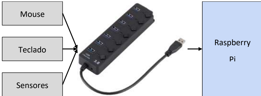
Figura 16. Conexión dispositivos USB con Raspberry Pi mediante HUB USB
