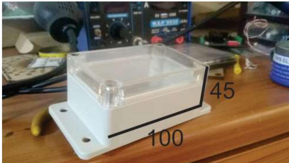
Figura 42. Carcasa plástica con cubierta transparente, totalmente hermética
