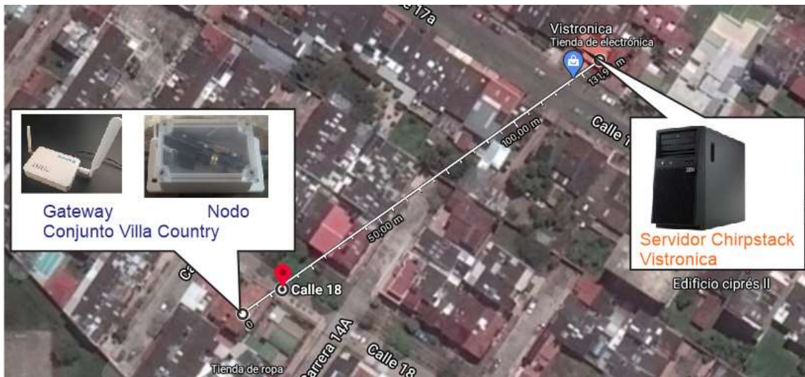
Figura 33. Prueba de conexión servidor ChirpStack y Gateway.
