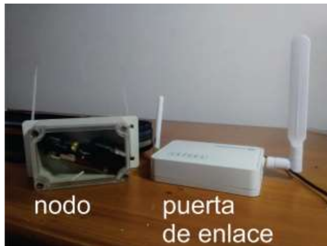
Figura 40. Izquierda Nodo o dispositivo que va en el cuello del animal y a la derecha la puerta de enlace Dragino.
