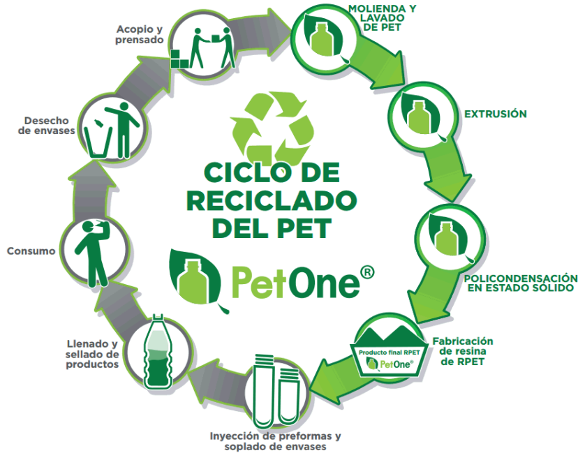
Ilustración 18. Ciclo de reciclado del pet
