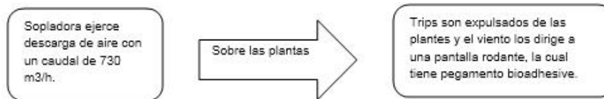
Imagen 18. Representación gráfica del proceso del soplado, (Fajardo, 2016)
