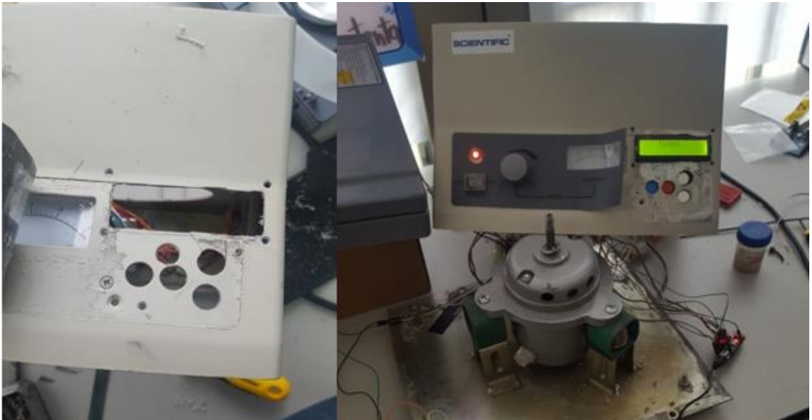
Figura 29 Ajustes al equipo para la instalación del temporizador digital. Fuente: Elaboración propia
