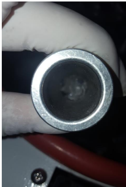
Figura 16 Residuos de vidrios encontrados en soporte de muestras
