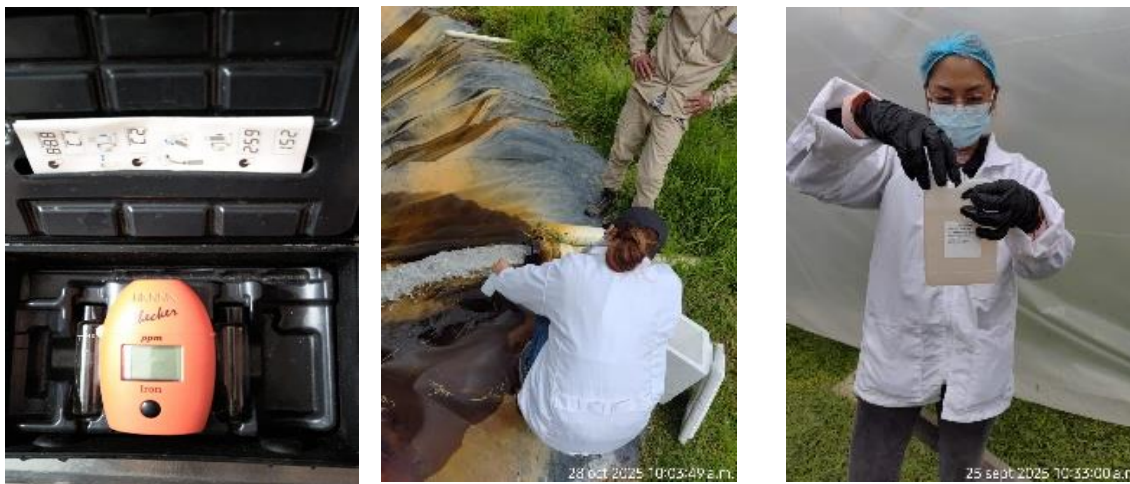
Figura 4. G) Equipo medidor de hierro, H, I) Toma de muestra de agua puntual.
