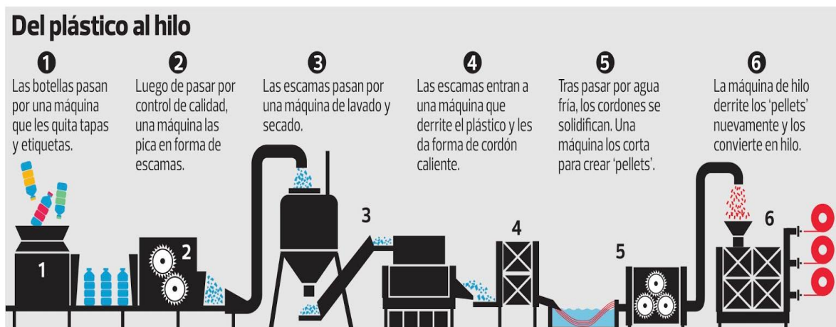
Ilustración 3 Proceso de peletizado de PET y PEAD recuperado
